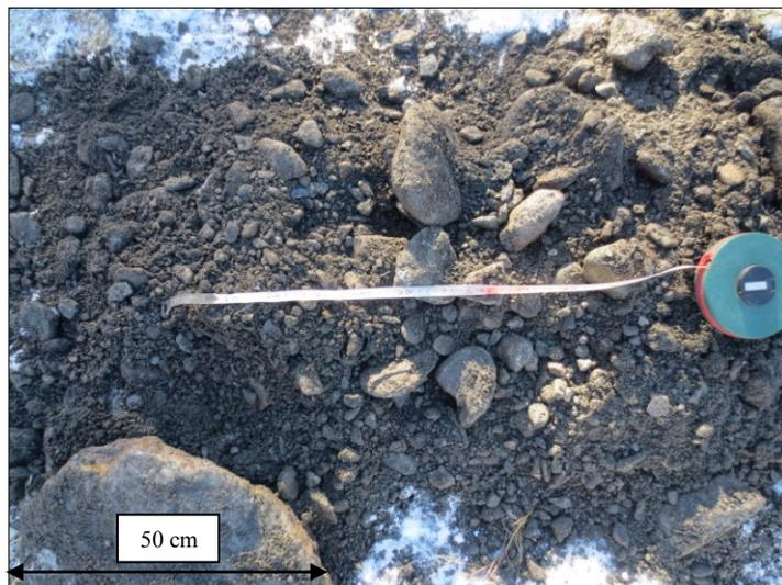
La matrice passa da limo sabbiosa (dai 230 ai 260 cm.) a sabbiosa e ghiaiosa con percentuali di limo da basse a molto basse. Dal semplice esame della rippabilità della benna a fondo scavo non sembra essere un deposito molto addensato/cementato, ciononostante non si sono verificati crolli o franamenti della trincea di escavazione, neppure con angolo prossimo alla verticale.
